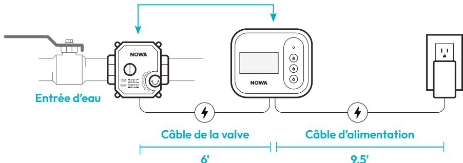
Le câble de la valve NOWA mesure 6 pieds et le câble d'alimentation du panneau de contrôle mesure 9,5 pieds. Il est recommandé d'avoir ou d'installer une prise électrique à moins de **9,5 pieds de la valve NOWA**. Si vous avez besoin d'un câble plus long, vous pouvez le rallonger avec un câble à 5 conducteurs 22AWG jusqu'à une longueur maximale de 60 pieds entre le panneau de contrôle et la valve NOWA.
